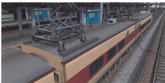
図3-8-12 「空気シリンダー」で「傾斜角」が変化する「パンタグラフ」を搭載
