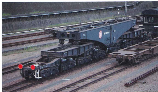
図3-7-5 最大「240t」の「変圧器」を組み込むことができる。隣の「コンテナ車」と比較すると、その巨大さがよく分かる
