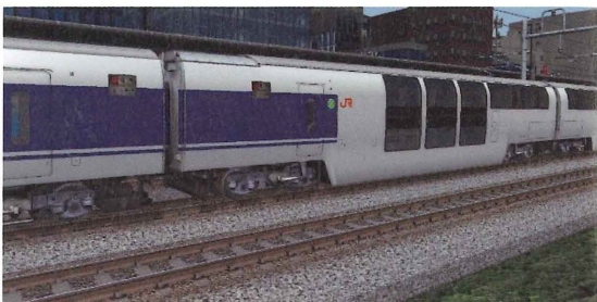
図3-8-16 グリーン+普通車は、2階建て。2階部分は、グリーン席。乗客の乗降ドアは、車体外部に移動する「プラグドア」を採用
