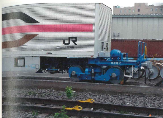
図3-7-9 トラック側の台車。単純にトレーラーに載せるのではなく、複雑な構造をもつ
