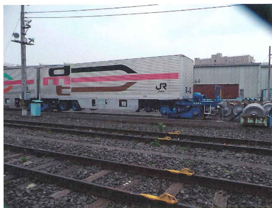
図3-7-8 「W100」。トラック輸送の「トレーラー部分」に「台車」をつければ、そのまま貨車になるという発想で試作された
