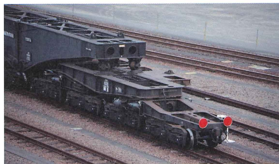
図3-7-6 「台車」「台车上枠」「枕枠」で構成された多段構造。台車は「NC-4A」
