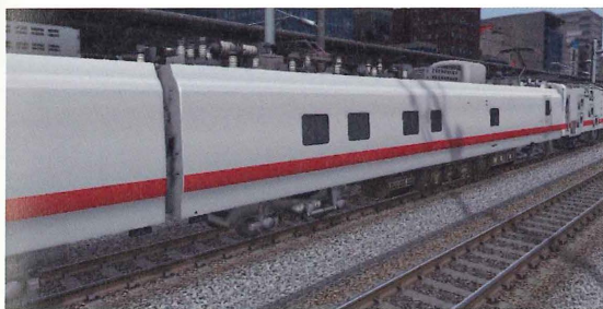
図3-8-18 架線測定器を搭載した「モヤE490-1」
