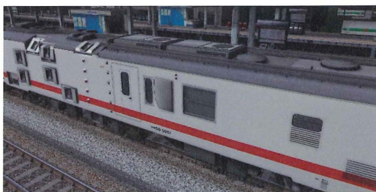
図3-8-22 屋根や床下にも測定装置を設置
