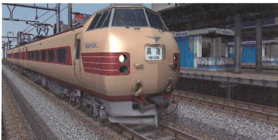
図3-8-13 高運転台の「Mc3」。台車は、最大傾斜「6度」のコロによる「自然振り子式」
