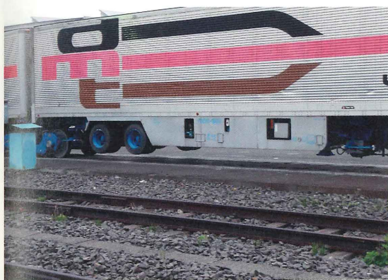
図3-7-10 タイヤ側。トレーラー間に「台車」を挟む「連接構造」になっている
