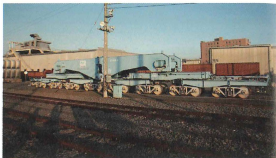
図3-7-16 「シキ800形式」としては30数年ぶりの増備車。基本的な構造は「シキ800」ですが、現代的なブレーキ装置など改良点が多数
