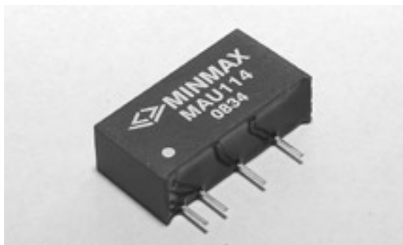
写真4-2 超小型の絶縁型DC-DCコンバータ・ユニットの例 写真はMINMAX MAU114で12V出力。このシリーズは出力3.3V～12Vの間で4種類がライン・アップされている。これらを使用すれば、簡単にアイソレートされた電源を得ることができる。
