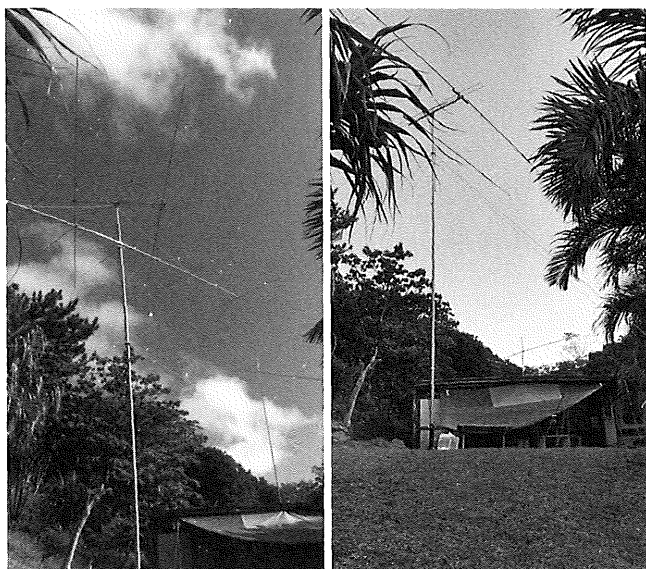
写真左：2024年5月の運用で設置した50MHz帯の7エレ八木とフルサイズの2エレHB9CV(24MHz帯に設定)。写真右：2023年秋のアンテナ、14/21/28MHz帯トライバンダーと50MHz帯の7エレ八木
