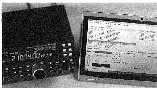
WSJT-Xを起動したノートPC(マイク内蔵)を、21.074MHz(21MHz帯のFT8標準周波数)を受信している無線機に近づけてみる(音量は適当に調整)。ケーブル類は何も接続していないのにFT8の解読が始まった
