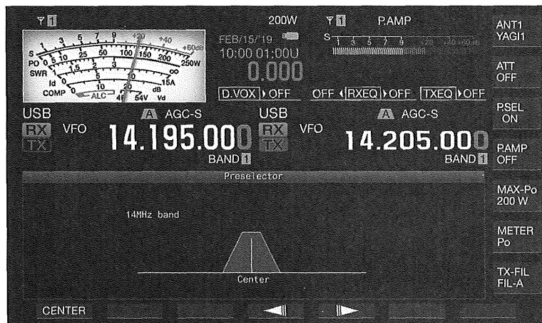
図12 一部のハイエンド機はプリセクターで効果的に放送局などの妨害波を低減できる(TS-990の例)
