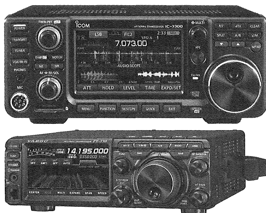
FT8の運用にはUSBオーディオ対応のオールモード機を使用するとよい。上(写真1)はアイコム IC-7300、下(写真2)は八重洲無線 FT-710 Field
