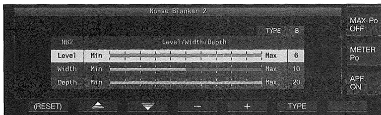
図13 最新機種ではノイズブランカーの種類やパラメーターを細かく設定できる(TS-890の例)
