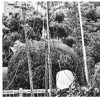
庭の片隅に立てたアンテナ。50MHz帯のモービルアンテナはブリキのバケツにマグネット基台を取り付けて設置
